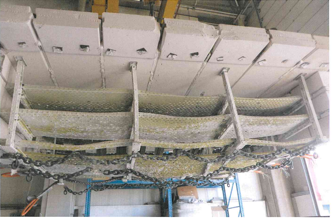
Resim B3: Numunenin aleve maruz kalan yüzeyinin test sonrası görünümü.
