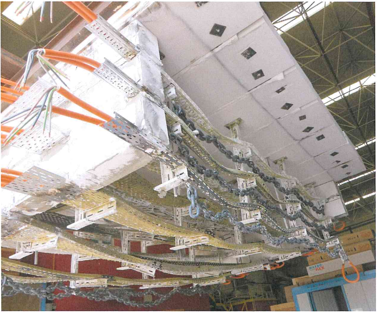
Resim B2: Numunenin aleve maruz kalan yüzeyinin test sonrası görünümü.
